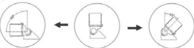
Fijación por soporte giratorio y tornillo, junto con soporte, soporte flexible, canal de aluminio o canal de aluminio con clip.
