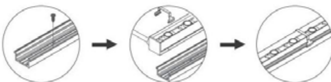
Fijación por canal de aluminio, clip y tornillo
