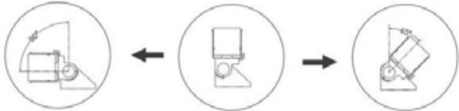
Fijación por soporte giratorio y tornillo, junto con soporte o canal de aluminio
